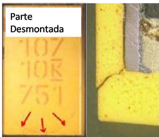
Figura 6. Vista frontal y corte transversal. (a) componente completo (la fisura está indicada con flechas rojas), (b) corte transversal donde se aprecia la condición de la fisura.
