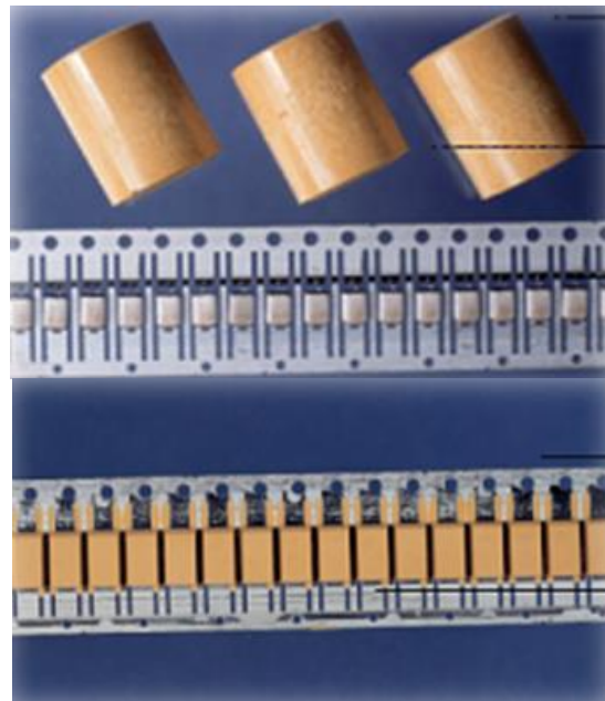
Figura 4. Molde de las partes. (a) pastillas de resina epoxica y Capacitores. (b) capacitores ya Moldeados (fotos tomadas del documento KEMET Institute of Technology (KIT) ).
